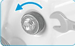
Desaperte os 4 parafusos de transporte com uma chave inglesa.
