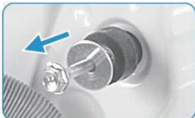
Retirer les boulons ainsi que les pièces en caoutchouc et conservez-les pour utilisation future.
