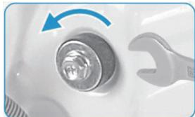
Déserrer les 4 boulons de transport à l'aide d'une clé.
