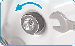
Lösen Sie die 4 Transportbolzen mit einem Schraubenschlüssel.
