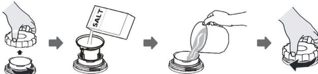
1. Retire o cesto inferior e desaperte a tampa do reservatório.
