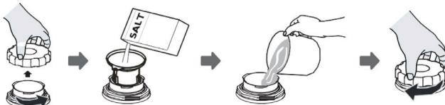
1. Retire la cesta inferior y desenrosque la tapa del depósito.
